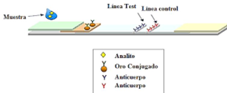
Figura 6. Principio de inmunocromatografía
