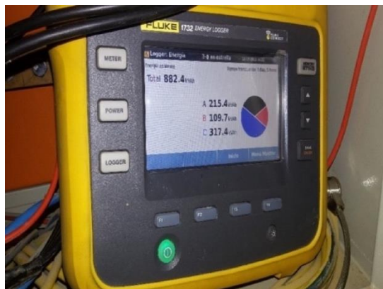
Figura N° 4: Analizador de red FLUKE. Fuente: Elaboración propia, 2019
