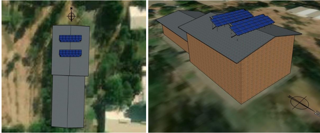
Figura 14: Vista de techo y lateral de la biblioteca de la Universidad con arreglo de paneles Solares. Fuente: elaboración propia, 2020
