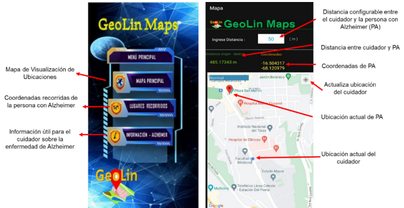
Figura 9. Pruebas de la interfaz y del funcionamiento del sistema. Fuente: Elaboración propia.
