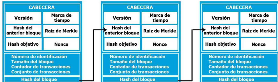
Figura 2. Estructura de bloque Bitcoin. Fuente: Elaboración propia basado en Nakamoto, 2008
