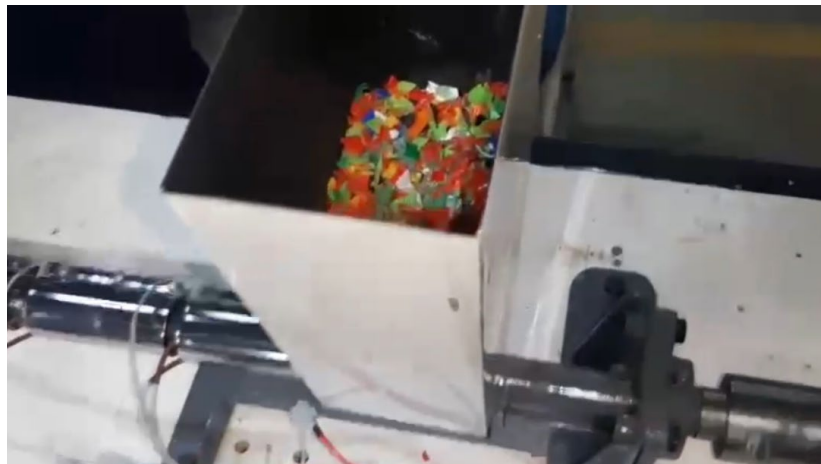
Figura 5. Ingreso de plástico en la extrusora. Fuente: Elaboración propia (2024).
