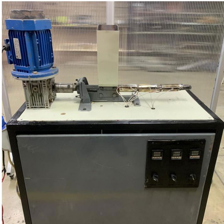
Figura 4 Extrusora de plástico. Fuente: Fotografía propia, tomada en el taller del Departamento de Electromecánica de la Universidad Privada del Valle (2024).
