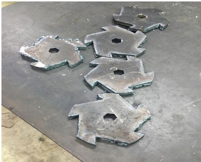
Figura 2. Cuchillas móviles. Fuente: Elaboración propia, tomada el taller del Departamento de Electromecánica de la Universidad Privada del Valle (2024).
