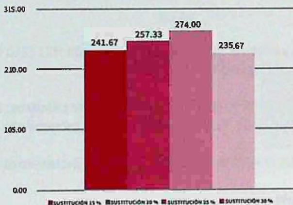
R22-R33: dosificación (h) 15-20-25-30 % sustitución reciclado e incremento de aditivos
