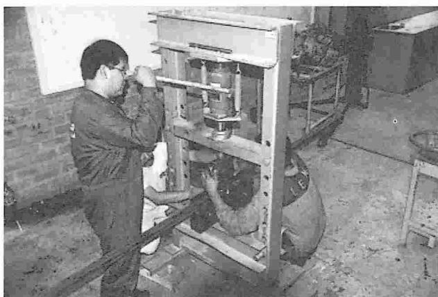
Fotografía 1: Proceso de doblado del tubo
