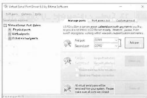
Figura N° 7. Configuración de dos puertos seriales virtuales en Eltima Software.
