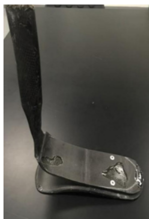
Figura 5. Prótesis unida con remaches
