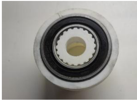
Figura N° 9. Instalación rodamiento externo en el asiento externo. Fuente: elaboración propia.
