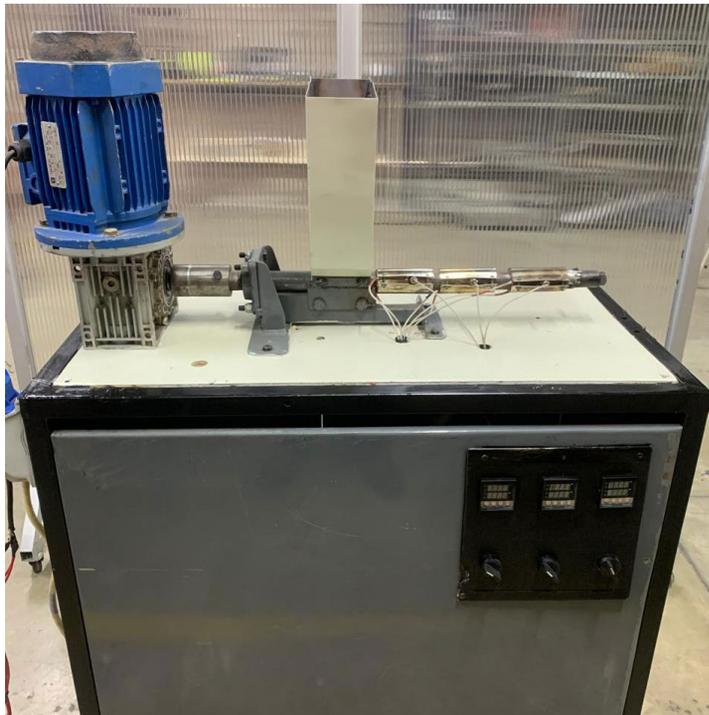
Figura 4. Extrusora de plástico. Fuente: Elaboración Propia (2024).
