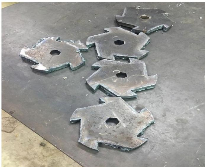
Figura 2. Cuchillas móviles. Fuente: Elaboración propia (2024).
