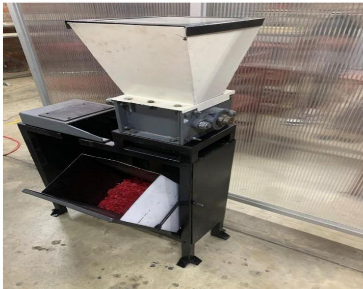
Figura 3. Picadora de plástico. Fuente: Elaboración Propia (2024).
