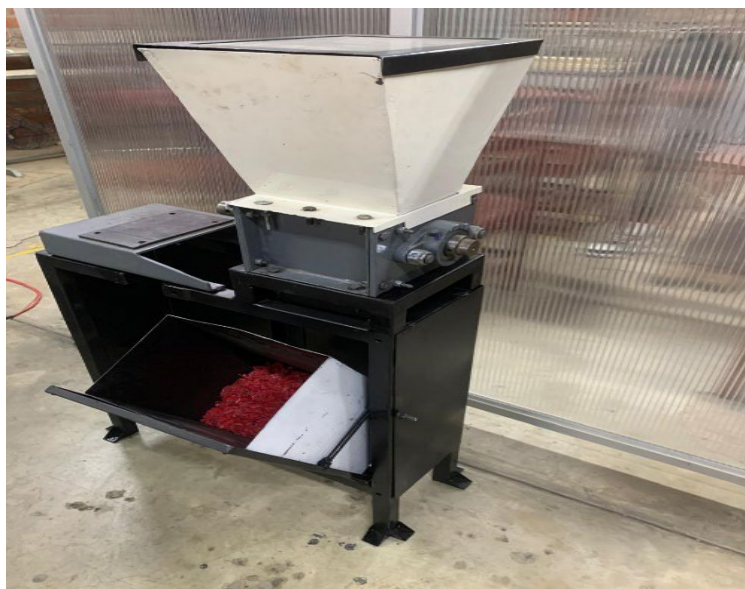
Figura 3 Picadora de plástico. Fuente: Fotografía propia, tomada en el taller del Departamento de Electromecánica de la Universidad Privada del Valle (2024).
